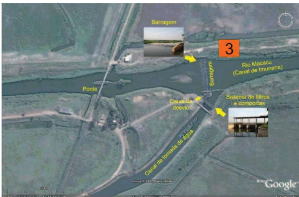
Sistema de captação da CEDAE no rio Macacu, através do Canal de Imunana.
