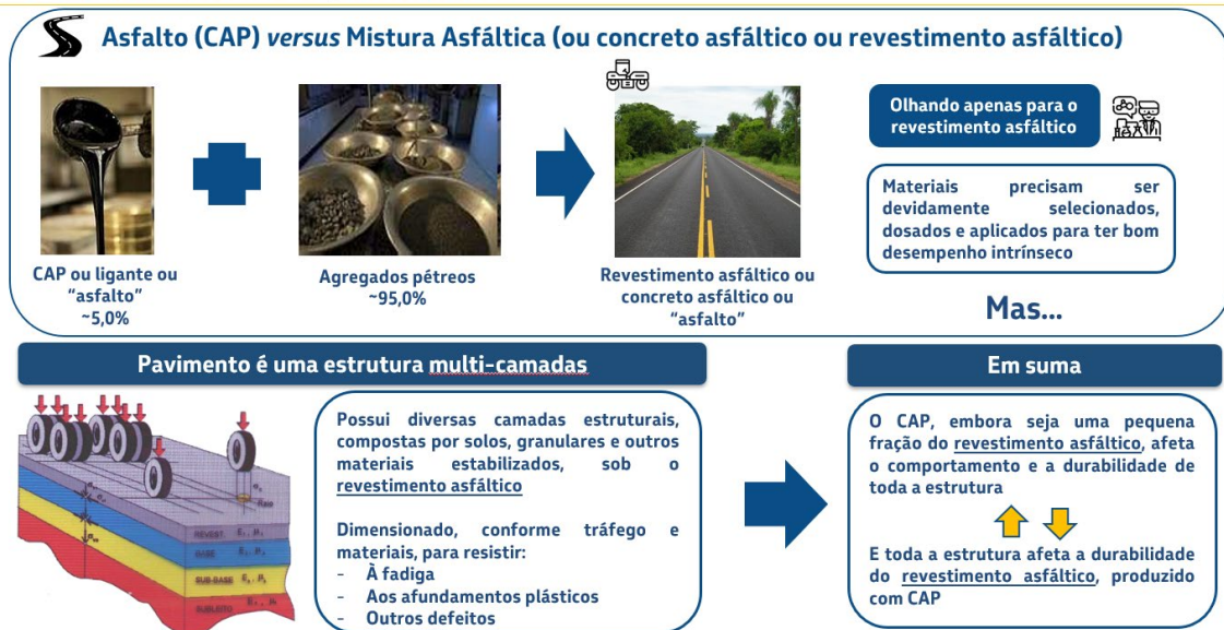
Figura I: Relação entre asfalto, mistura asfáltica e pavimento
